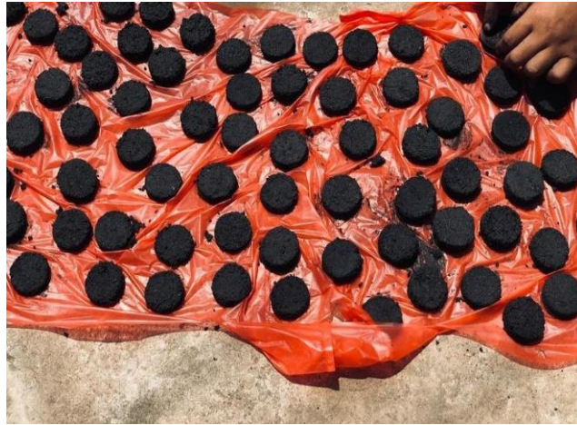
Gambar 11 . Proses Pengeringan Briket.
